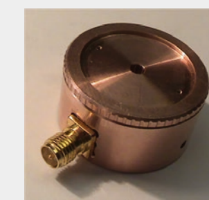
Корпус детектора с разъемом для подключения
