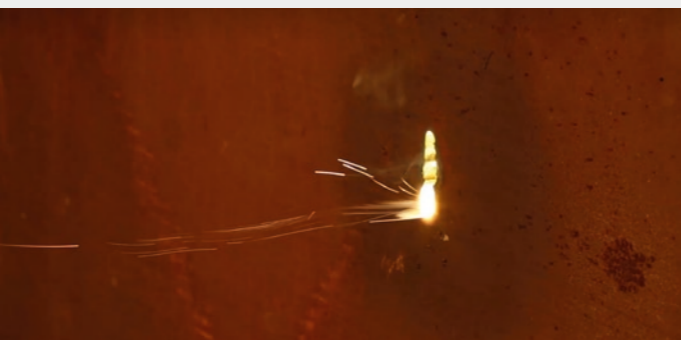
Резка толстостенного металла, имитирующего корпус атомного реактора
