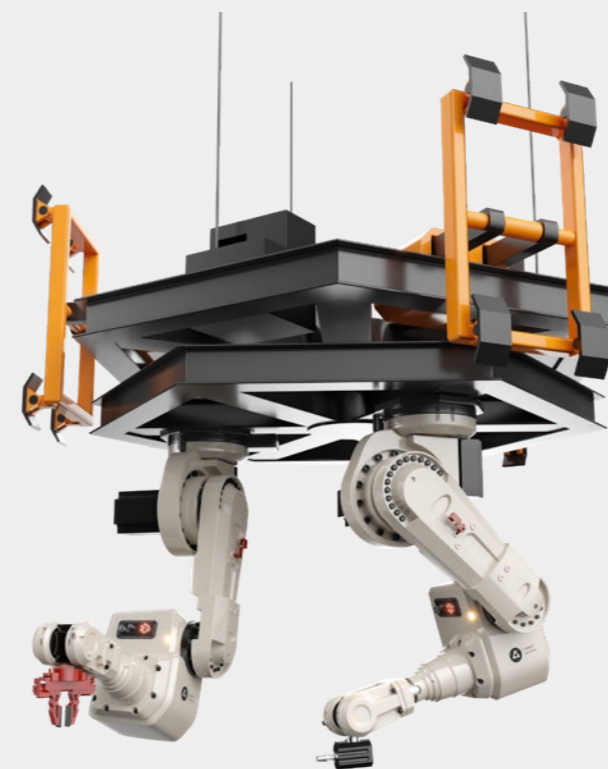
Один из возможных сценариев использования МЛТК - резка элементов корпуса реактора АЭС
