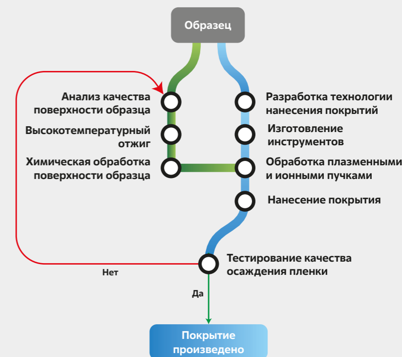
Применение защитных покрытий к корпусам детекторов
