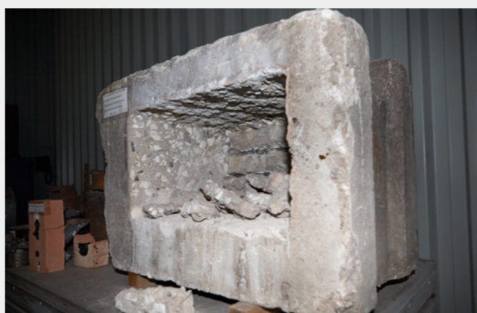
Лазерное сверление и резка бетона
